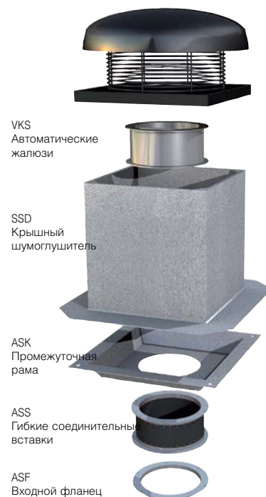
DHS Пример сборки Аналогично для серий DVS, DVN, DVC
